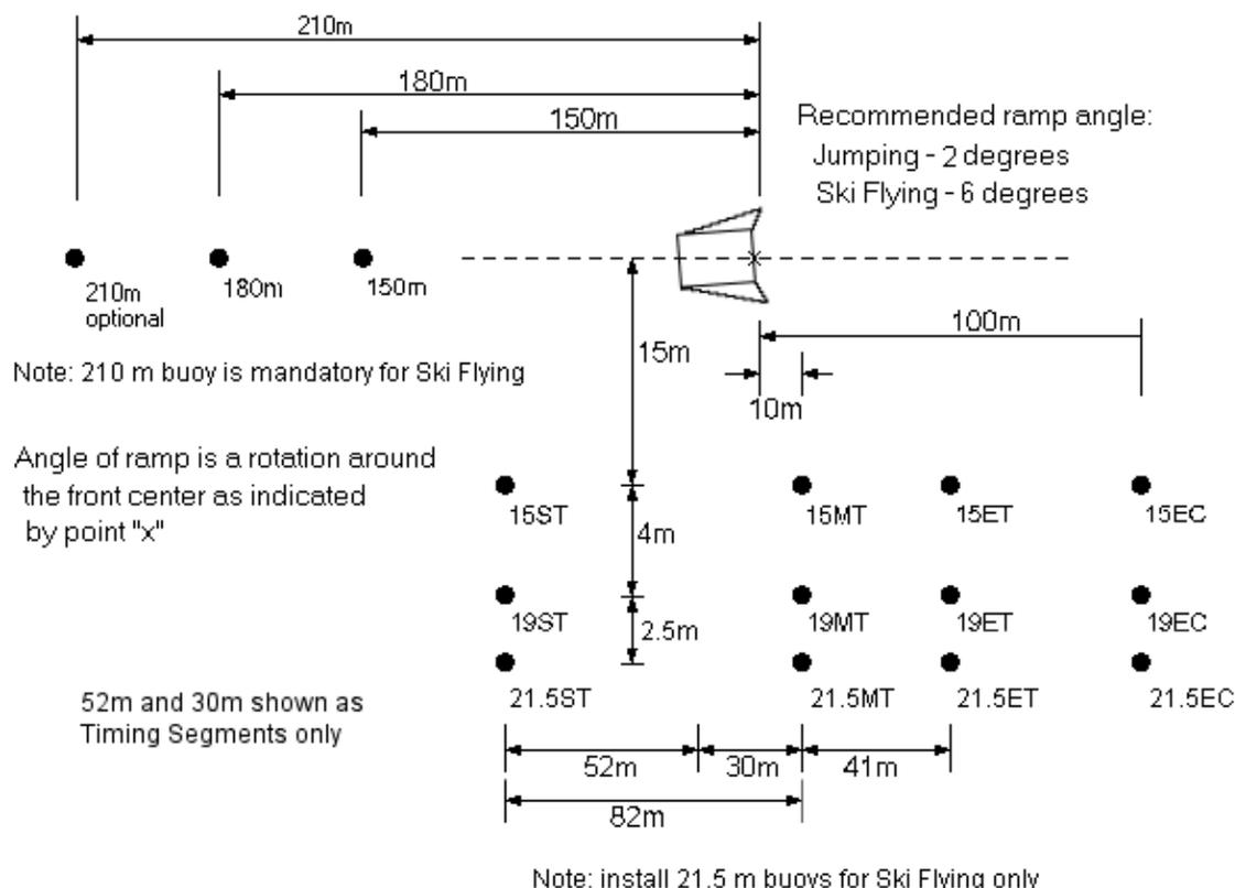
L'axe du tremplin doit être parallèle au chenal de saut et légèrement ouvert. La tolérance pour le saut est comprise entre  $+1.00^\circ$  et  $+2.50^\circ$  en ouverture.
