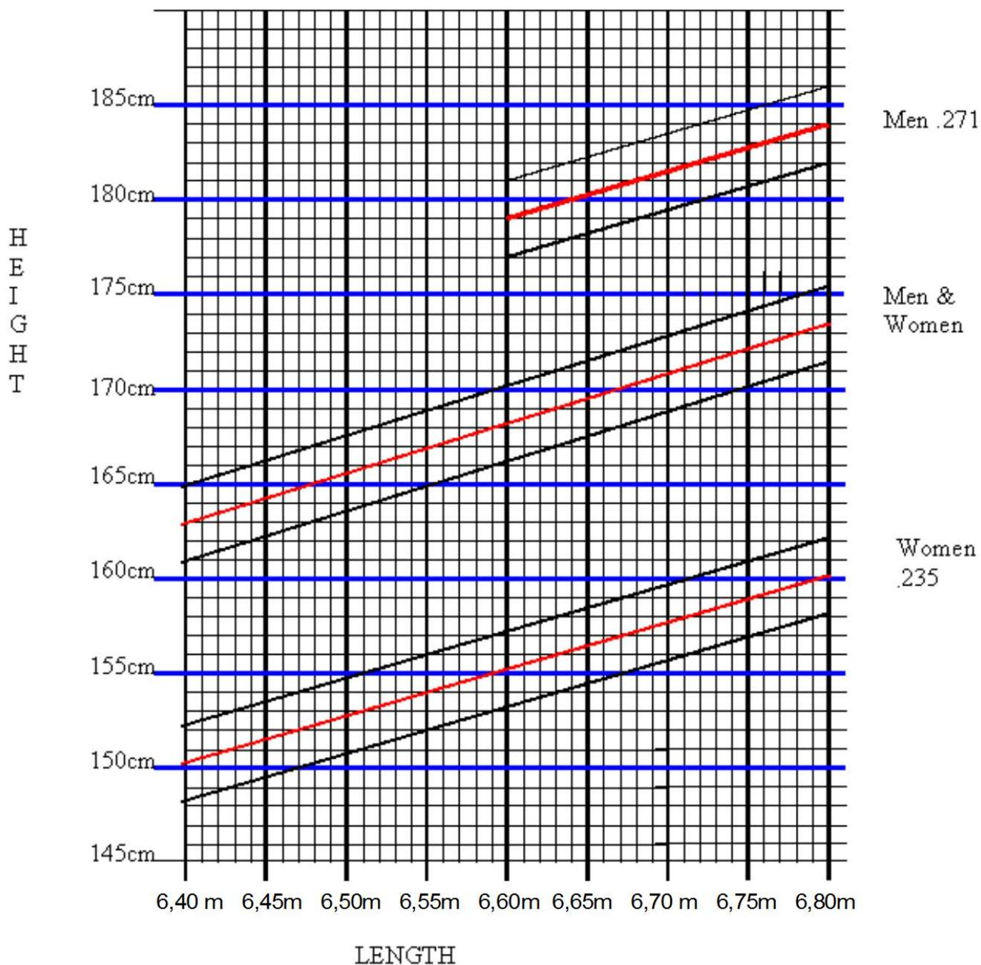
Instructions : Pour tout réglage du tremplin, utiliser le rapport entre la HAUTEUR prise au bord supérieur et la LONGUEUR hors d'eau selon le diagramme entre les lignes continues. Réaliser de préférence un réglage qui se rapproche le plus de la ligne pointillée (médiane)
